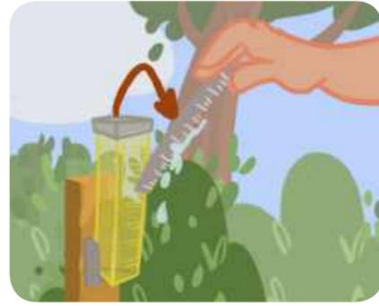
Sacar el pluviómetro de la base tratando de no derramar líquido.
